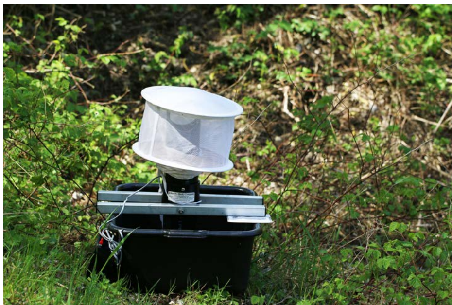
Past za lov gravidnih samic, ki privablja oplojene samice, ki iščejo primerno mesto za odlaganje jajčec. V črni banjici je voda. Ko pride samica blizu, jo ventilator posrka v lovilno mrežico, iz katere ne more ven. (foto: Tea Knapič)
