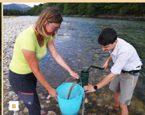
Globlje v prod lahko pridemo z uporabo prenosne votle cevi, ki je na koncu preluknjana. Po zabijanju cevi do izbrane globine (A) s pnevmatično črpalko načrpamo vodo (B) in jo prefiltriramo preko ročne mreže. Ta metoda se imenuje metoda Bou-Rouch. (foto: D. Tome)
